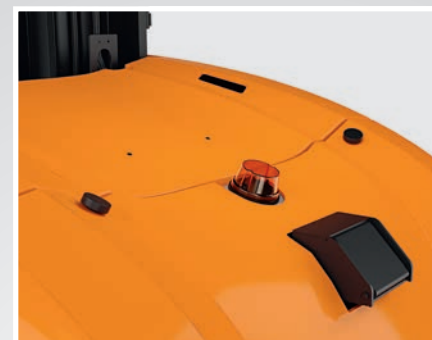
Schnelles Laden sichert hohe Verfügbarkeit: Der direkte Ladezugang am PXV ist dafür eine wichtige Voraussetzung und erleichtert die Handhabung der Ladesteckverbindung für alle Mitarbeitenden enorm
