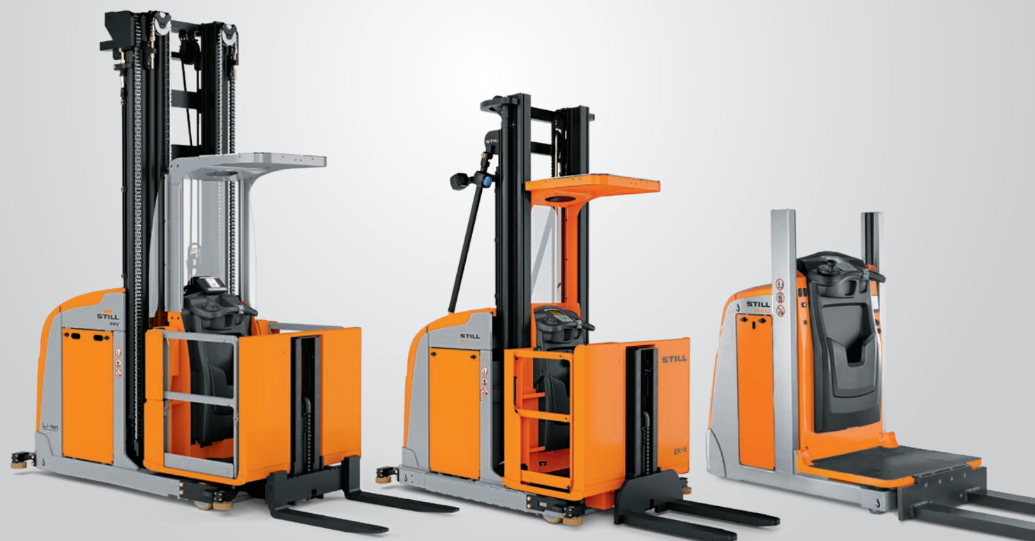
PXV: Dreifach-Hubgerüst, Greifhöhe bis 14,5 Meter
